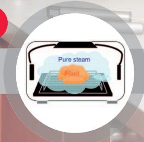
Der separate Dampfgenerator erzeugt reinen Wasserdampf in einem Temperaturbereich von 70 °C bis 100 °C
